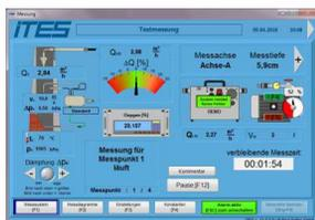
Parameter und Daten werden in Echtzeit auf dem PC gespeichert. Bei Stromausfall kein Datenverlust!
