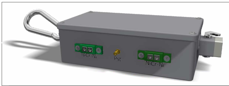
Sensorbox für Psychrometer für zwei Thermoelemente und ein Drucksensor
