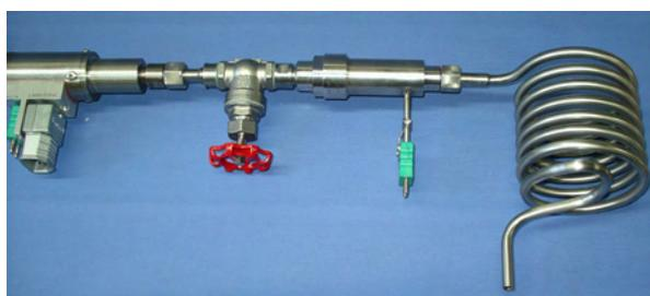
Absaugrohr mit Ventil, Filter mit Thermoelement und Kühlschlange
