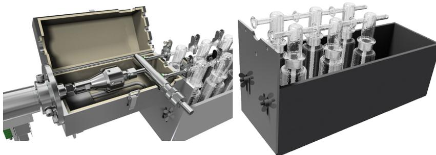
Heizung am Absaugrohr montiert (Flansch), mit Filterkopf und Gasverteiler zu zwei Waschflaschenstraßen. Feste Montage des Waschflaschenkastens an der Heizung.
