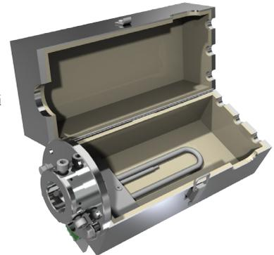
**Gasverteiler** für die Trennung des Absaugvolumens in zwei Teilvolumenströme, z. B. ein Hauptvolumenstrom für die Isokinetik-Regelung und konstante Teilvolumenströme für Waschflaschen. Überwurfmutter G 1/2 für Ausgang Filterkopf, 90° dazu Ausgang mit Aussengewinde G 3/4 mit Schnellkupplung, gerade: 2 x Gewinde für Adapter. Material: Titan
